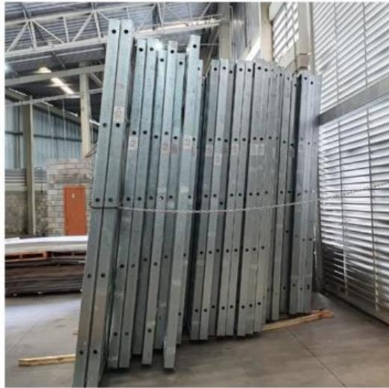
Figura 32-Estoque de painéis de parede
